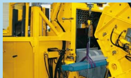
Минимальное время простоя оборудования благодаря специальному устройству для замены зубьев (опция)
