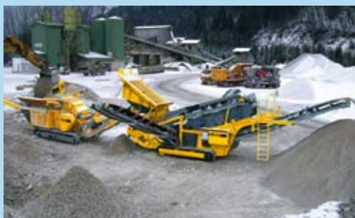
Совместное использование дробильной установки RM80 с виброгрохотом TS3600 позволяет достичь максимальной прибыли за счёт получения фракционированного конечного продукта
