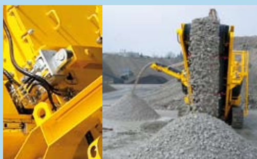
Возможность получения различных конечных фракций за счёт применения гидравлической системы регулировки затора дробления
