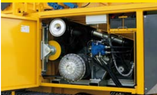
Незначительный расход топлива благодаря эффективной дизель-электрической концепции привода (ок. 17 л/ч)
