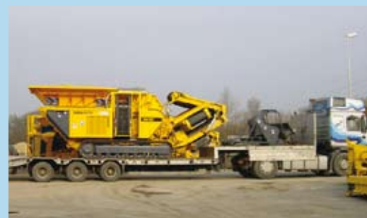
Прибыль за счёт мобильности: RM80 и OS80 вместе с обратным конвейером транспортируются на одном низкорамном прицепе
